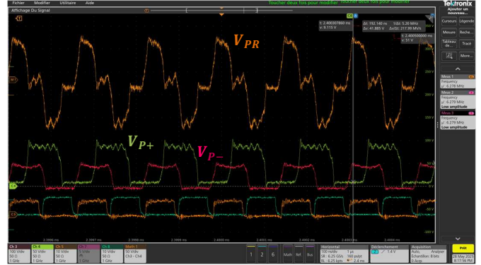
Fig. 18 Oscillogrammes de la tension aux bornes du PR sur le channel math 1. Tension primaire et secondaire du PR respectivement channel 4 et 3. V_{gs} des transistors high-side et low-side.
