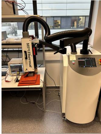
Fig. 7. Banc expérimental de caractérisation thermique des PR – utilisation d'une machine de test thermique TA-5000A de MPI Thermal.
