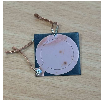
Fig. 14 Résonateur avec ring (anneau) autour de l'électrode active
