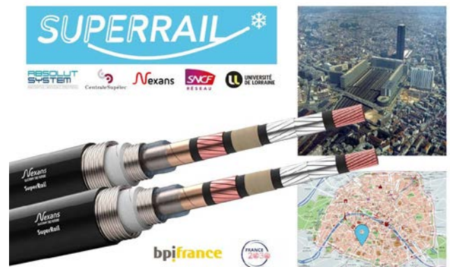
Fig. 1. SuperRail - le premier système commercial de câbles HTS à courant continu pour le réseau ferroviaire.
