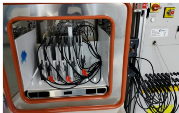
Figure 3. Mini modules PV dans une enceinte climatique pour le test PID pendant 96 h à 85 °C et 85% RH.
