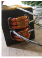
Figure 2 - Noyau EE bobiné avec 3 spires d'un fil de Litz de 432 brin de 0.1 mm au primaire et au secondaire, dimensions géométriques du noyau
