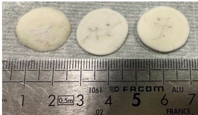
Fig. 3. Image de pièces d'alumine élaborées par CIP après la découpe.
