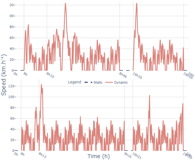
Figure 4 : Exemple de profil de vitesse généré par l’outil de construction des usages, dans le cas mobilité mixte (haut) et mobilité quotidienne (bas).
