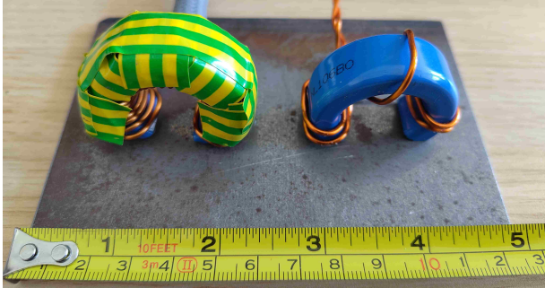
FIG. 11. Photo des deux inducteurs et de la plaque en acier ferromagnétique à chauffer
