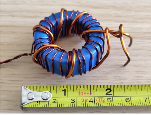
FIG. 15. Photo du transformateur
