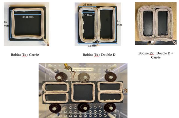
Figure 3: Prototypes de bobines à échelle réduite ( bobines Tx double D, et carrées).
