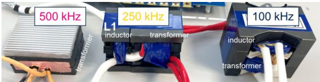
Figure 12 12 – Transformateurs pour le convertisseur dc-dc pour 3 fréquences -500 kHz : 0.091 litres - 250 kHz : 0.187 litres - 100 kHz : 0.232 litres
