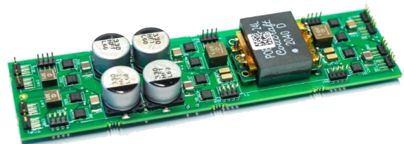
Figure 3. Photo d'une CSC AC/DC intégrant plusieurs blocs standardisés. Tous les composants formant cette CSC sont issus de séries de composants disponibles sur étagère sous plusieurs valeurs, calibres, rapports de transformation
