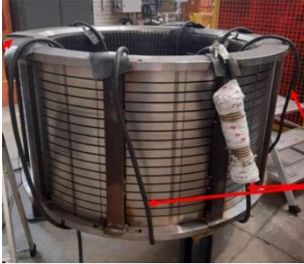
Fig.2. Image d'un stator en essai de magnétisation [H. Helbling, 2]
