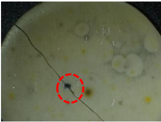
Fig. 3. La surface de l'échantillon BC4361 après un claquage.
