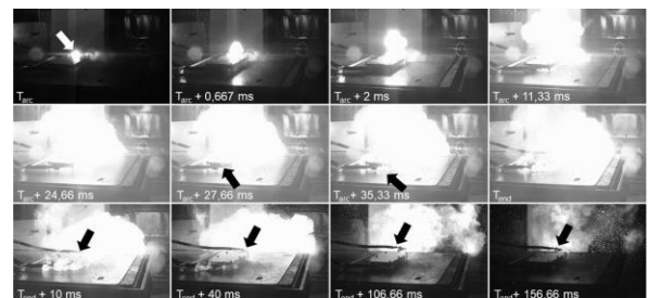
Figure 10 : Observation à la caméra rapide du test de l'accumulateur E63B
