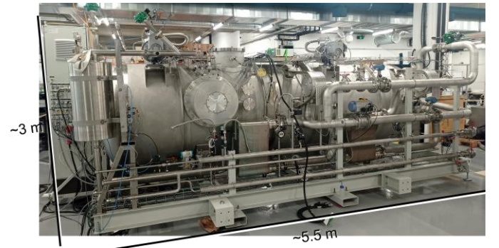
Fig. 8. Illustration du système de refroidissement de type Turbo-Brayton Inversé développé par Absolut System dans le cadre projet SuperRail [23], [24].
