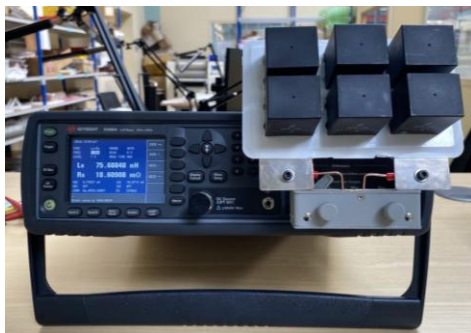
Fig. 5. Dispositif de mesure de l'inductance de l'ensemble Bus bar + condensateurs, avec un pont RLC
