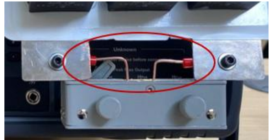
Fig. 13. Connectiques de mesure d'inductance utilisée avec la méthode 1 de mesure
