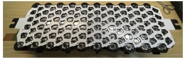
Fig. 1. Exemple de bus bar d'interconnexion de cellules, laminé (film isolant en blanc)
