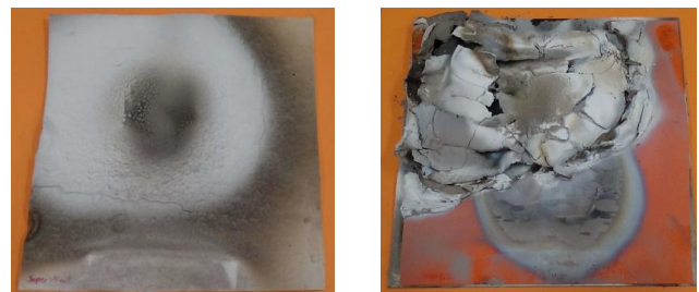
Fig. 13. Résultats de l'essai de flamme pour les matériaux 3 et 4
