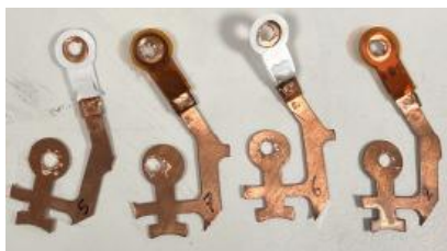
Fig. 8. Eprouvettes pour essais de surcharge et d'échauffement, avec différents isolants protégeant la fonction fusible.
