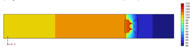
Fig. 5. Comparaison des simulations de passage de courant (20A) avec et sans refroidissement du conducteur
