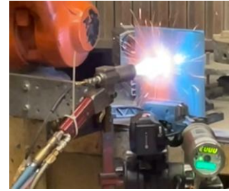
Fig. 11. Dispositif de test à la flamme avec projection d'alumine
