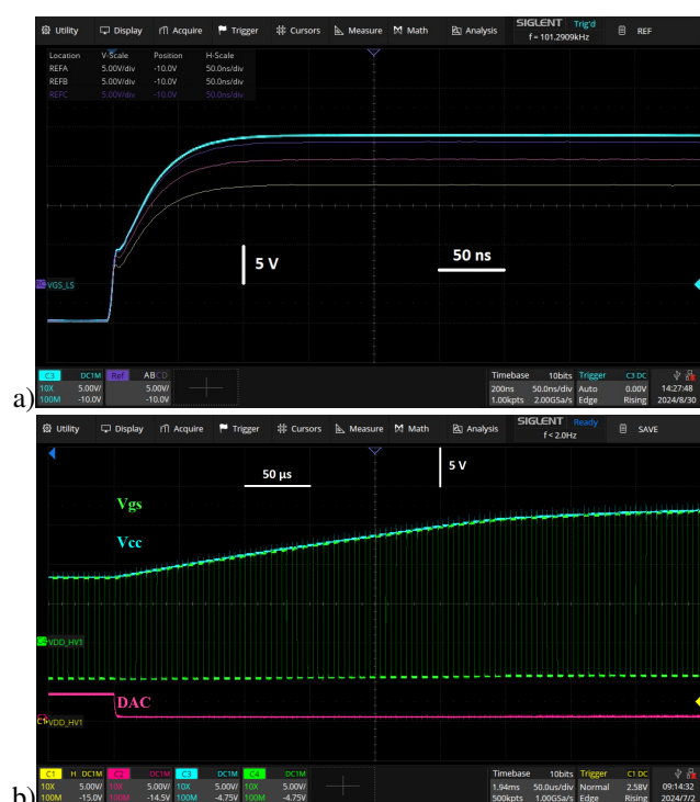
FIG. 9. Validation du réglage de la tension de commande de grille, en fonctionnement et sans puissance. a) Zoom sur la charge de grille du MOSFET SiC, pour différentes tensions d'alimentation isolée réglées numériquement. Séquences enregistrées et mises en référence. b) Tout en envoyant un signal de PWM à 120 kHz en continue, ajustement à la volée de la tension isolée de commande.
