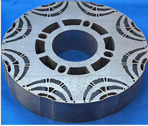
Fig. 1. Design final de la machine réalisé avec des barrières fluides.
