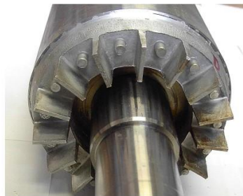
Fig. 5. Prototype du rotor à « boucle isolée » [9].
