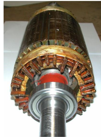
Fig. 3. Prototype du rotor à « double couche » [9].
