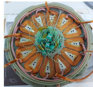
Fig. 7. Induit réalisé en fil de Litz.
