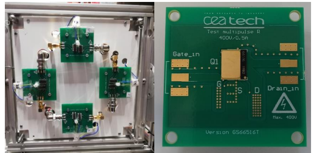
Fig. 3 : Cartes de test. A gauche, 4 cartes supports montées sur le cadre de l'enceinte sous vide d'irradiation. A droite, une carte coupon de test avec transistor, qui se connecte sur les cartes supports.
