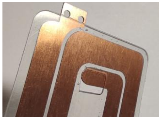
Fig. 18. Dépôt d'isolant par fabrication additive.
