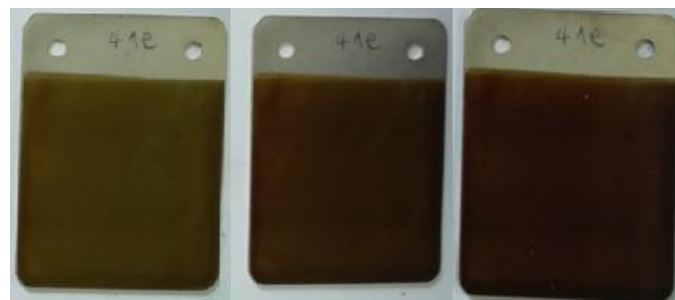
Fig. 9. Vieillessement à 200^{\circ}\text{C} de la formulation finale sur une couche de 150 \mu\text{m} à 8, 16 et 24 h.
