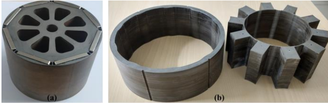
Fig. 2. (a) : Rotor avec ses 8 aimants parallélépipédiques NdFeB ; (b) : Couronne (gauche) et étoile (droite) statoriques
