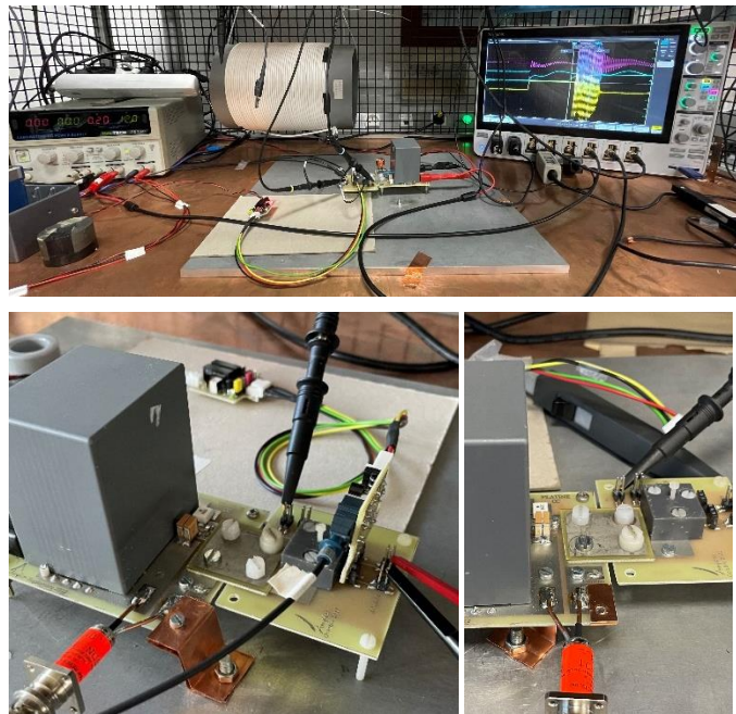
Figure 7 : photo du banc expérimental (plan large (en haut) et zoom de la configuration 1 (en bas à gauche) et de la configuration 2 (zoom en bas à droite).
