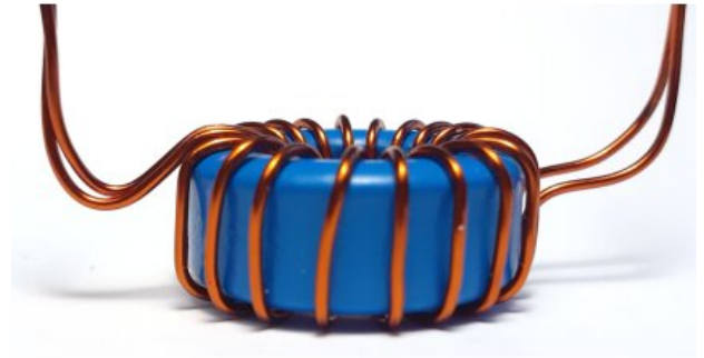
FIG. 1. Noyau toroïdal à deux enroulements.
