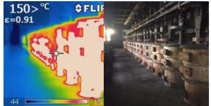
Fig. 1. Images thermique et dans le visible d'une batterie de BAF.
