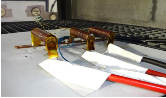
Figure 6 : essais de trois accumulateurs en parallèle en surcharge
