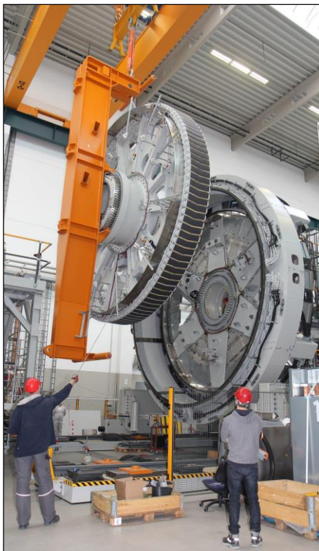
Fig. 13. Plateforme de tests d'Enercon à Aurich (Allemagne) [78] / Alternateur à excitation bobinée.
