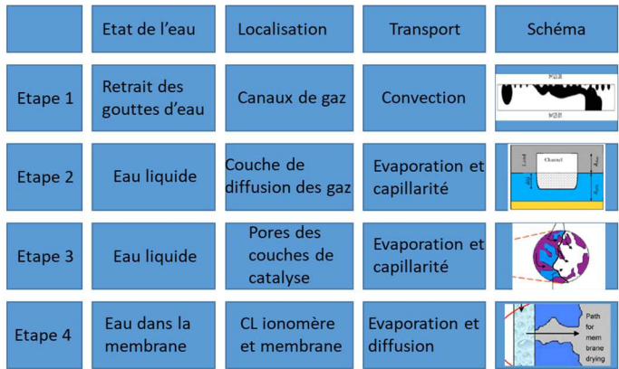
Fig.4. Séquences d'évacuation de l'eau d'une PEMFC [15]
