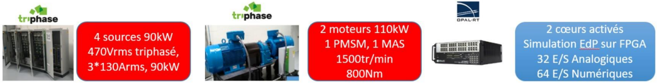
Fig 2: Schéma du modèle P-HIL du système houlomoteur SEAREV
