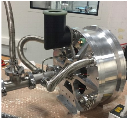
Fig. 2. Moteur supraconducteur de 50 kW et son système de refroidissement
