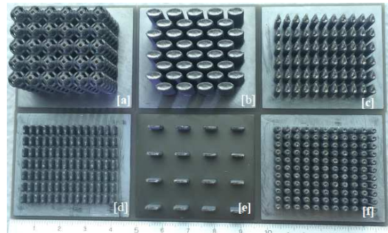
Figure 4 : Exemple de différentes géométries de dissipateur thermique réalisées par FAM SLM; a) structure lattice, b) picots elliptiques, c) picots en forme de goutte, d) et e) picots rectangulaires, f) picots cylindriques
