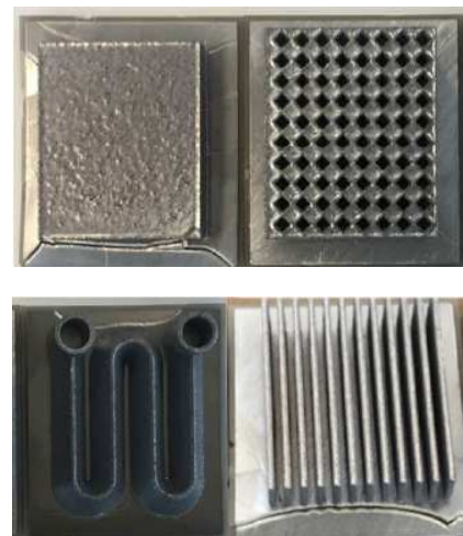
Figure 5 : Exemple de différentes géométries de dissipateur thermique réalisées par FAM SLM induisant une rupture de la céramique du substrat
