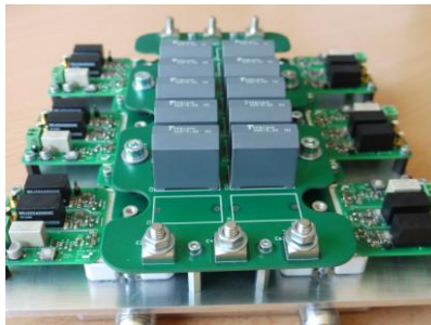
Fig. 10. Onduleur 10kW réalisé pour valider les modèles
