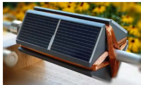
Fig.2 Photo du rotor d'un moteur à énergie solaire.
