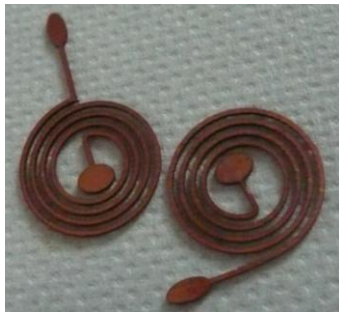
Figure 4 : Spirales usinées par électro-érosion.
