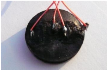
Figure 7 : Coupleur (TIC). Diamètre 20 mm.
