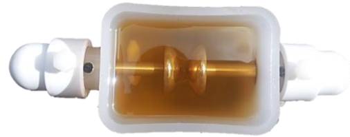
Fig.5 Cellule d'essais du diélectromètre avec des électrodes VDE immergées dans 400 ml d'EMHP
