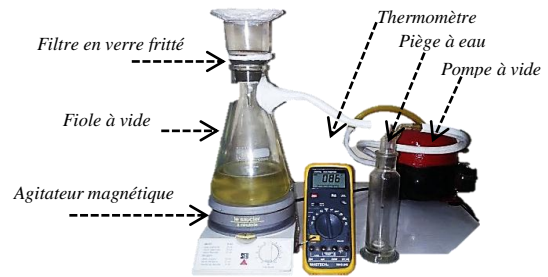
Fig. 3 Station de dégazage des EMHP
