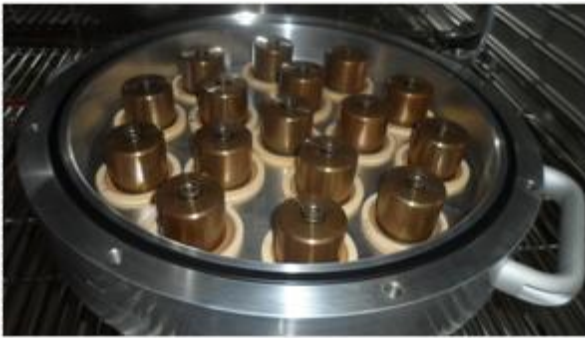
Figure 4. Mise en œuvre des échantillons pendant le vieillissement électro-thermique
