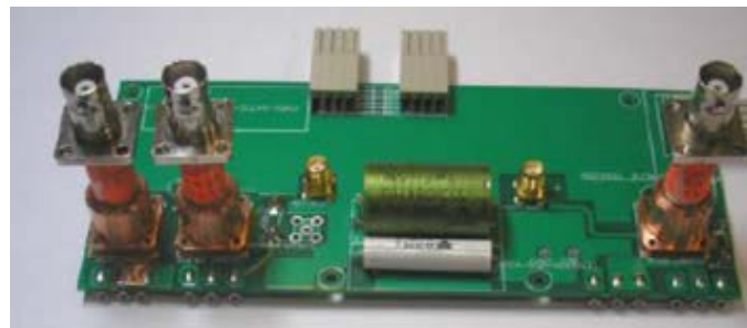
Figure 3 : Carte du bras d'onduleur réalisée
