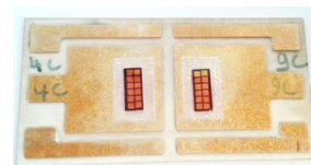
Figure 5 : Véhicule de test après le frittage d'argent.
