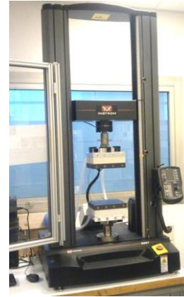
Figure 4 : Presse Instron équipée de plateaux chauffants.
