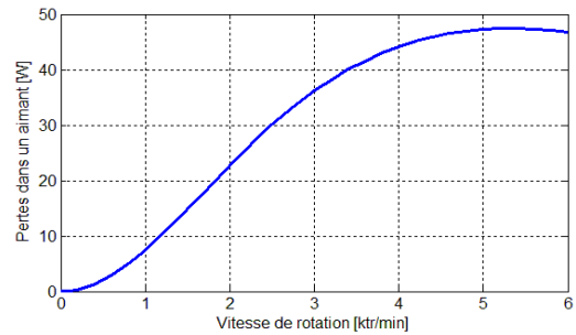
Fig.14 Evolution des pertes d'un aimant en fonction de la vitesse de rotation du rotor.
