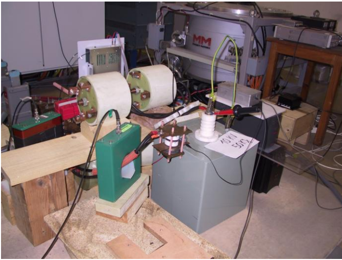
Fig.5 : Montage expérimental avec un condensateur de puissance au premier plan, au milieu le convertisseur et, à l'arrière plan, le générateur MDS
