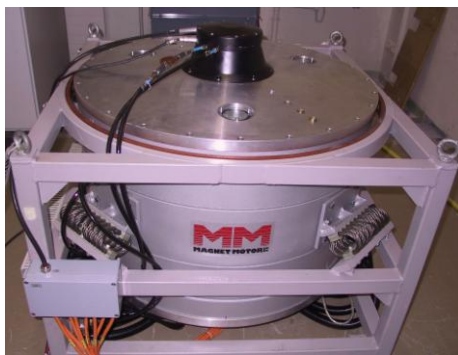
Fig.3 : Volant d'inertie utilisé comme source de puissance du convertisseur (MDS : Magneto-Dynamic-Storage)
